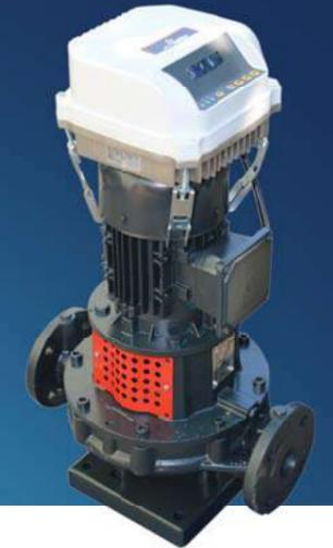
Одноступенчатые насосы подходят для использования в системах отопления, соответствующих директиве VDI 2035, в хозяйственных системах горячего и холодного водоснабжения, в системах охлаждения/ конденсации, в смесях вода/гликоль. Вал насоса герметизирован механическими пломбами, насосы требуют минимального технического обслуживания и обладают хорошим бескавитационным режимом.
